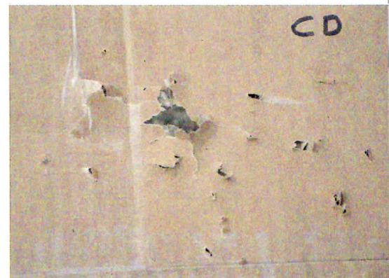
Viele energiearme Splitter bei Hohlsplitzgeschossen
