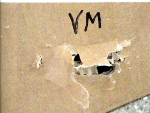
Kurzwaffe: kompakter Restkörper und wenige Splitter bei Vollmantel- (l.) und gebondeten Hohlsplitzgeschossen (r.)
