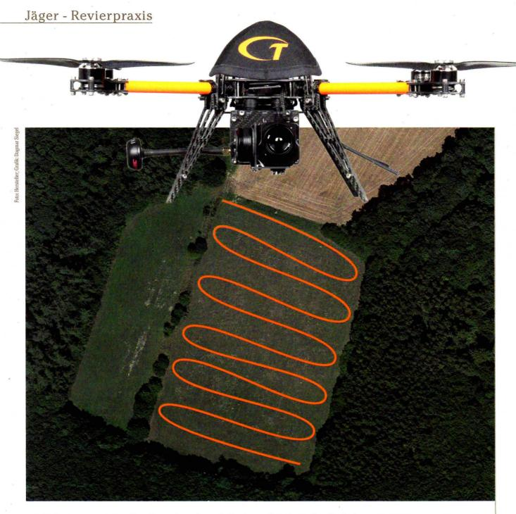
Mithilfe eines speziellen Algorithmus berechnet die Drohne selbstständig ihre Flugbahnen. Die Bilddaten werden an die Empfangseinheit in Echtzeit übermittelt, sodass direkt gesehen werden kann, ob ein Kitz auf der Wiese liegt.
