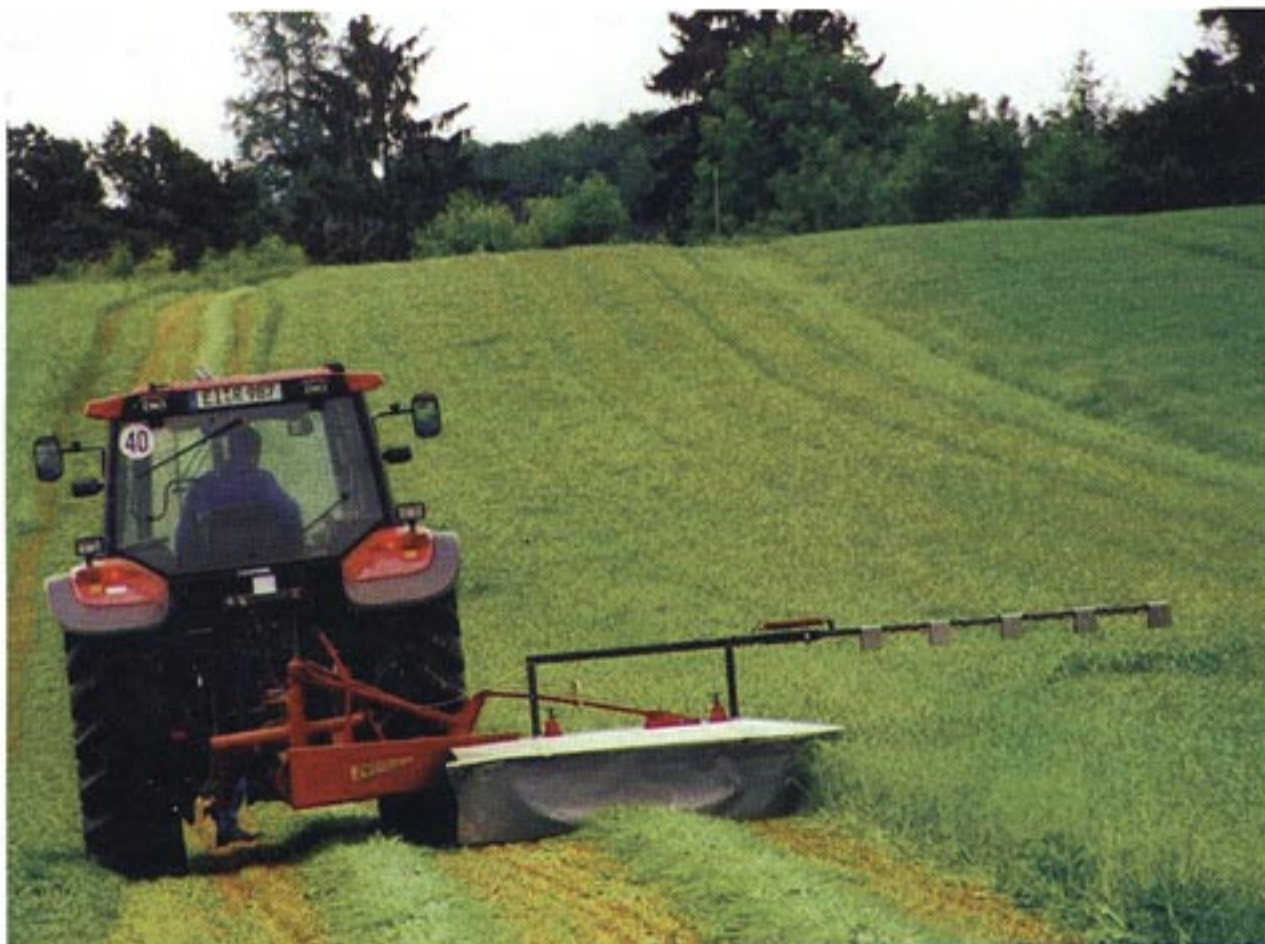
Warnung vor dem Kitz: Die Infrarotsensoren am Kreiselmäher alarmieren den Landwirt rechtzeitig, bevor im hohen Gras versteckte Tierjunge oder Vogelküken in die Messer geraten
