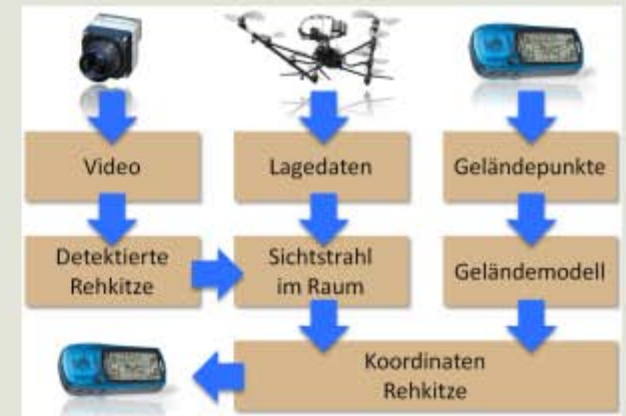
Rehkitzrettung mit UAV und Thermalkamera
