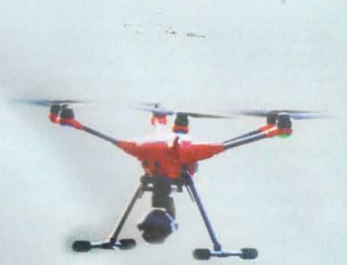
Die Kamera unter der Drohne erfasst neben dem normalen Bild auch die Wärmesignaturen von Lebewesen.
