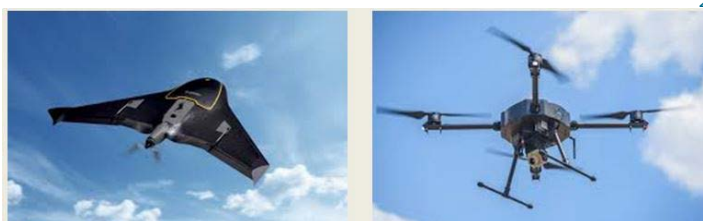
Links een fixed wing en rechts een multicopter
