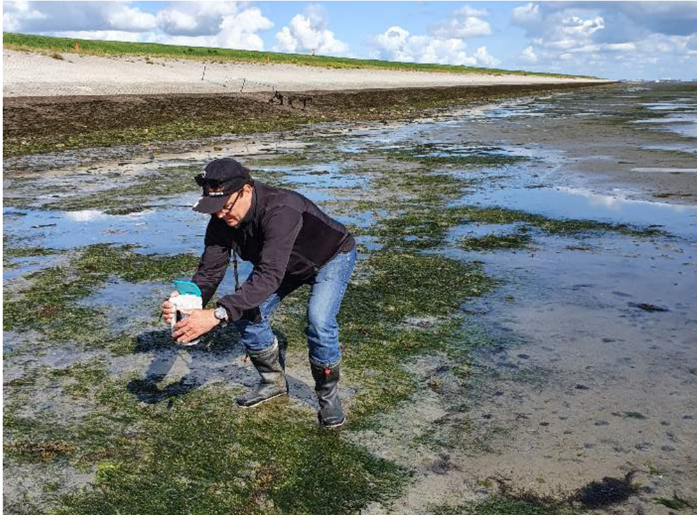
Figuur 22 Meting klein zeegras bij Krabbendijke met de handheld Fieldspec Pro
