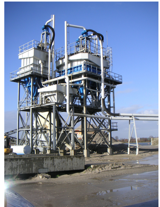
Foto 3 (boven) Het omhoog gezogen materiaal wordt met behulp van grote installaties gezeefd en verdeeld over verschillende fracties.
