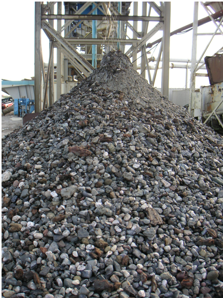
Foto 3 (boven) Het omhoog gezogen materiaal wordt met behulp van grote installaties gezeefd en verdeeld over verschillende fracties.
