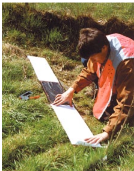
Figuur 6.16 Inktstempel met papiervellen op multiplexplaat.
